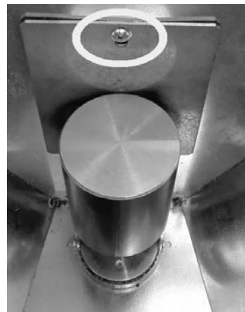
Fig. 112 - Entfernen der Schraube
