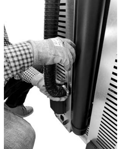
Fig. 56 - Rohr der Heizluft einstecken
