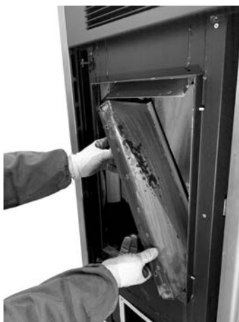
Fig. 100 - Die Seitenwände entfernen
