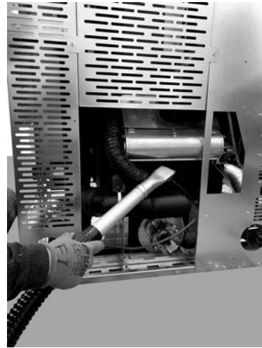
Fig. 109 - Reinigung Raumventilator (Mithos 3 Plus 12/14)
