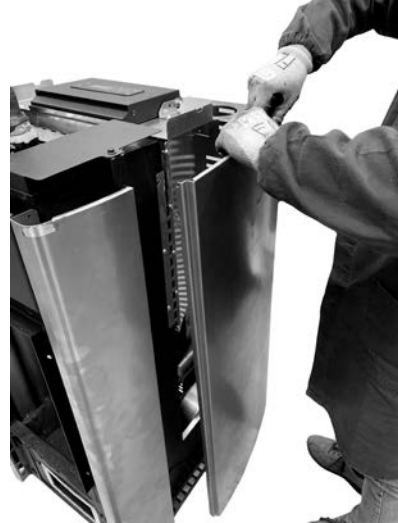
Fig. 29 - Die Seitenteile entfernen
