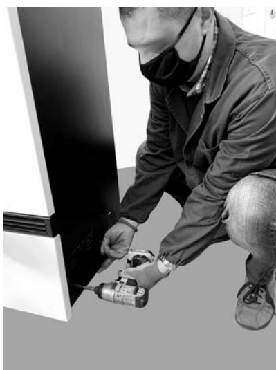
Fig. 45 - Lösen der Schrauben
