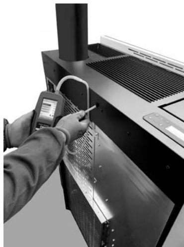
Fig. 90 - Anschluss des Digitaldruckwächters (Mithos³ Plus12/14)
