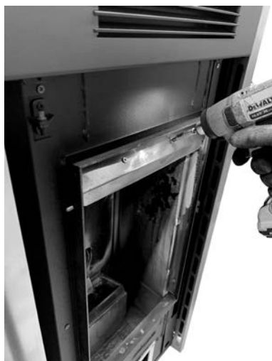
Fig. 96 - Das Umlenblech entfernen
