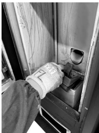
Fig. 91 - Die Brennschale entfernen
