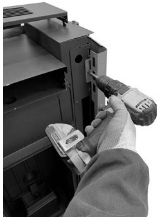
Fig. 31 - Die Schrauben entfernen
