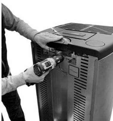
Fig. 49 - Stopfen entfernen (Atena)
