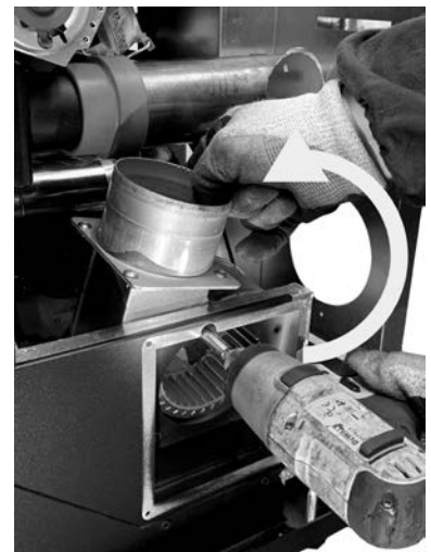
Fig. 63 - Den Ventilator drehen
