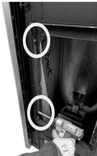
Fig. 97 - Die Sechskantschrauben entfernen
