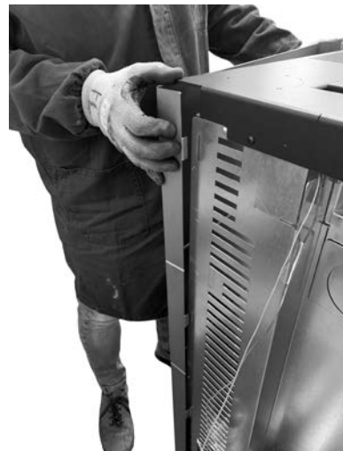
Fig. 27 - Die Seitenwand abnehmen
