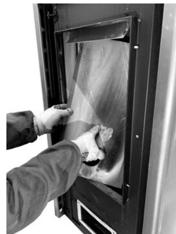
Fig. 101 - Die Rückseite des Feuerraums entfernen
