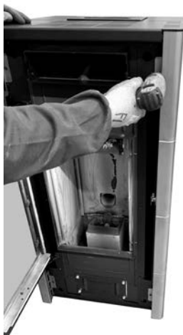
Fig. 26 - Die Schrauben entfernen
