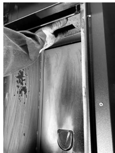
Fig. 98 - Die Stirnseite des Feuerraums 1 entfernen
