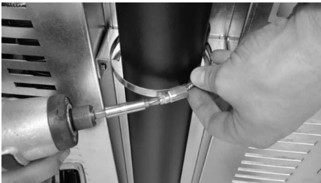
Fig. 57 - Mit Schellen fixieren
