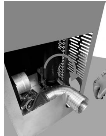
Fig. 73 - Den Schlauch drehen
