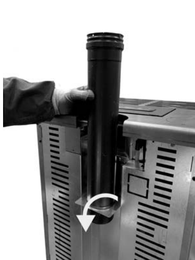
Fig. 51 - Halterung absenken
