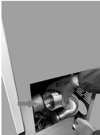
Fig. 72 - Den Schlauch abziehen
